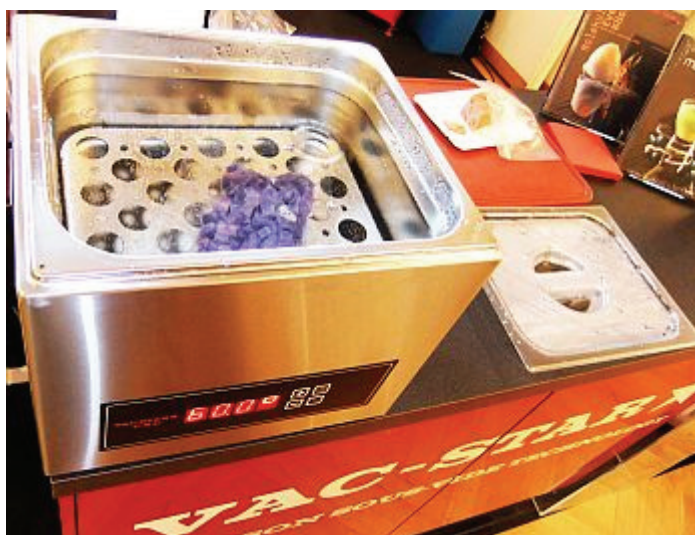
Vax-Star offeriert auch Hobbyköchen ein fast zehntelgradgenaues und erschwingliches Wasserbad, um Fleisch oder Gemüse in Folie vakuumiert zu garen (Sousvide). Durch Pulsen der Heizleistung erzeugt es Blasen, welche die Wasserzirkulation fördern. Dies ist wichtig, um mehrere Beutel gleichzeitig zu garen bei konstanter Temperatur. Bei grossen Bädern gibt es auf Wunsch einen Einstechfühler.
